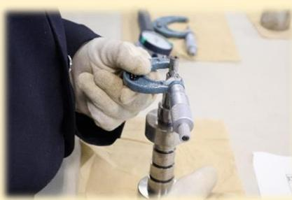
シリンダゲージによる内径測定④
