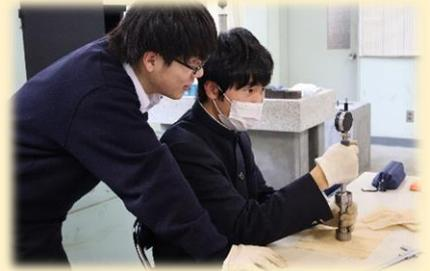
三針法によるネジの有効径測定
