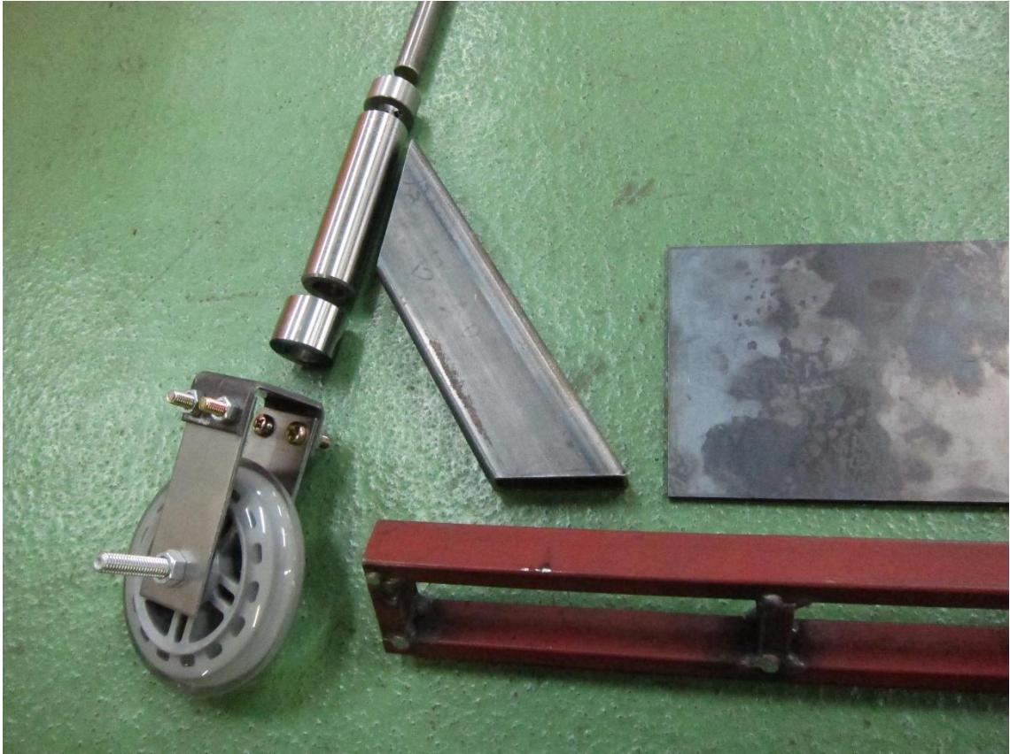
製作途中のキックボードの前輪付近アップです。
