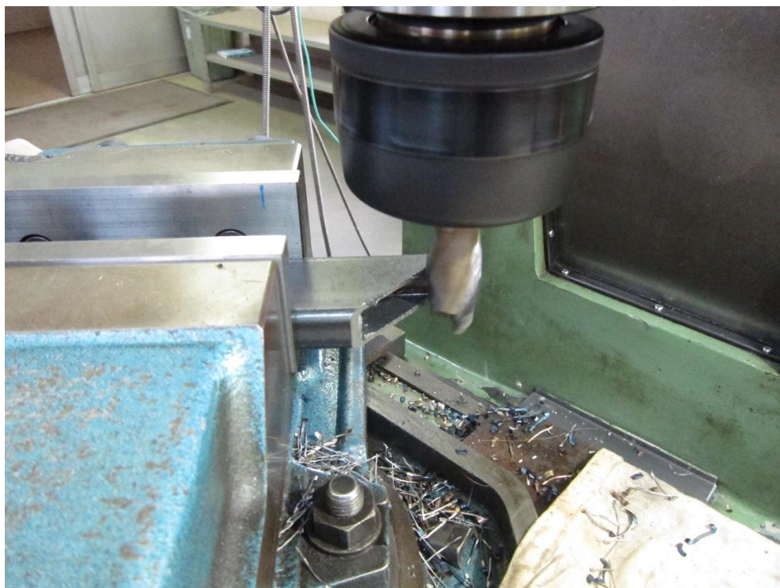
切削部のアップです。下に落ちているものは切りくずです。
