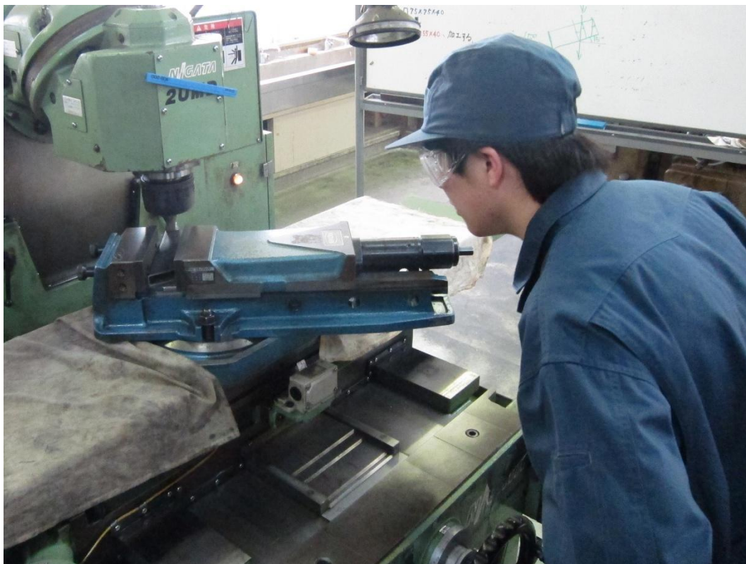
立てフライス盤という機械で、材料を斜めに切削しています。
